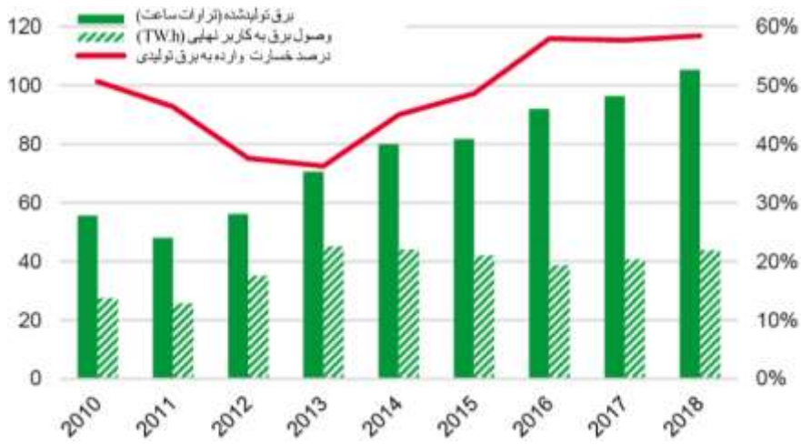
شکل (۲.۱۶) تولید برق در مقابل نسبت تحویل شده به کاربر نهایی
